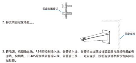
源线、视频线、RS485控制线告警输入线、告警输出线——对应连接。线缆连接请参照设备实际所
