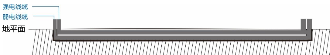
图 3-12 预埋 PVC 管道
