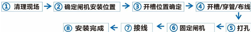
图 3-1 闸机安装流程
