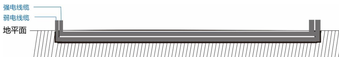
图 3-7 预埋 PVC 管道
