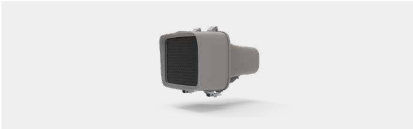
该产品采用气体放电及LED混合补光，具有回电时间短、寿命长、补光柔和等特点，专门针对AI超微光场景研制开发。采用精确的控制电路，与摄像机做到100%的同步。支持日夜模式切换，白天使用高亮度补光，夜晚使用低亮度补光，消除光污染，最大限度减少对驾驶员及周边居民的干扰和影响。
