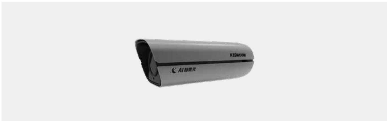
产品采用一体化机芯镜头，变焦过程全程清晰；内置NPU神经网络加速引擎，采用科达自主研发AI超微光深度学习图像增强算法，搭配大靶面CMOS图像传感器，极大提升了摄像机在夜晚微弱补光环境中的人脸抓拍亮度和清晰度，图像色彩还原真实。护罩一体化交付，IP67防护等级，方便室外安装维护。
