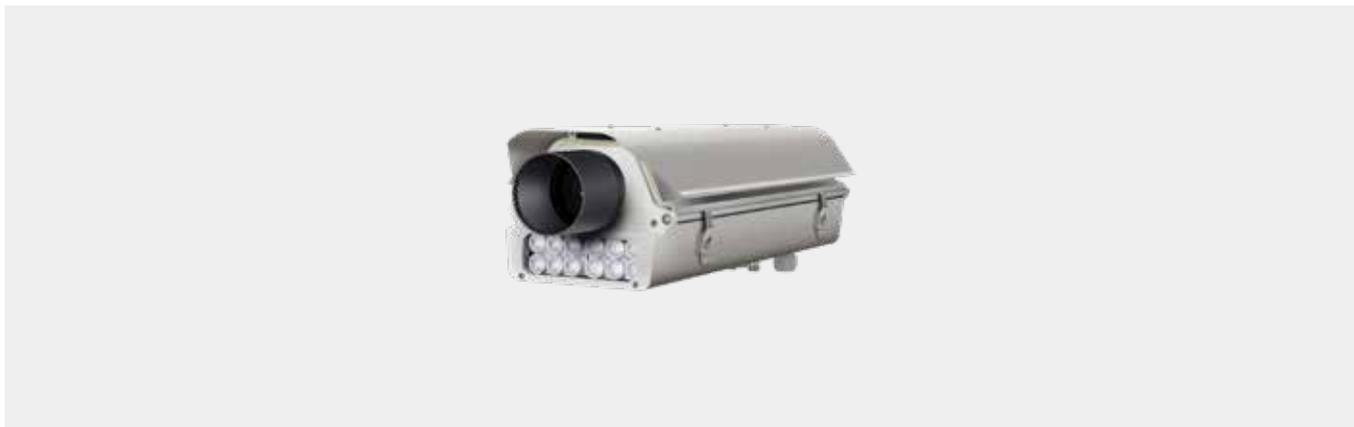
智能卡口单元采用1英寸高性能图像传感器，有效像素900万，一体化交付设计，包含摄像机防护罩、光学处理机构、高清摄像机、综合控制模块等部件，实现视频检测、车辆抓拍、补光控制、图像处理、图片合成、数据传输对联等功能，抓拍图片具有高清晰度、高灵敏度、高画质、AI图像低照增强等特点。
