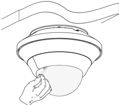
**【注意】** 非红外款设备无球罩，请在安装结束后撕去镜头保护贴膜及固定胶带。
