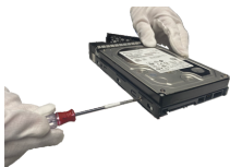
④ 用螺丝钉（4颗）将硬盘固定在硬盘盒中 注意：请务必将硬盘正确固定在硬盘盒中。
